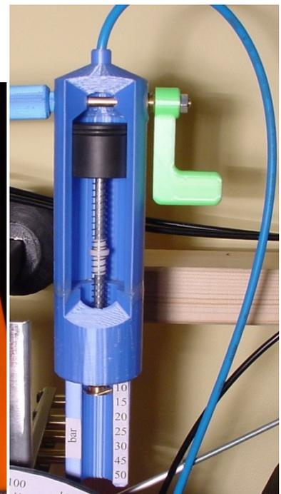
6. Mit der Kühlwasserpumpe wird Wasser als Schmierung und Kühlung zum Zylinder und zu den Ventilen gepumpt.
