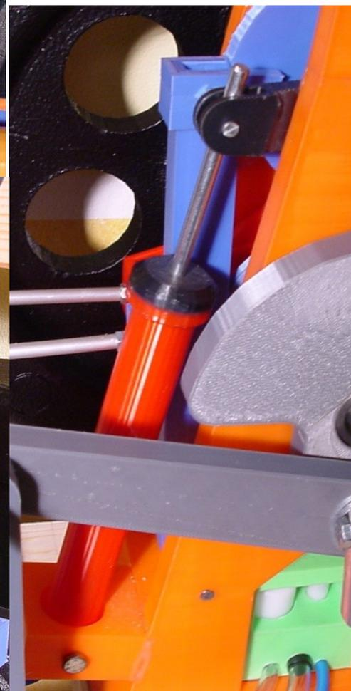
9. Die Steuerkurve 1 und 2 steuern Primär- und Sekundärluft, die Steuerkurve 1 steuert zusätzlich den Brennmaterialvorschub
