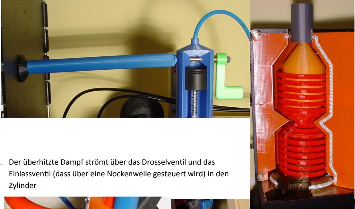
2. Der überhitzte Dampf strömt über das Drosselventil und das Einlassventil (dass über eine Nockenwelle gesteuert wird) in den Zylinder
